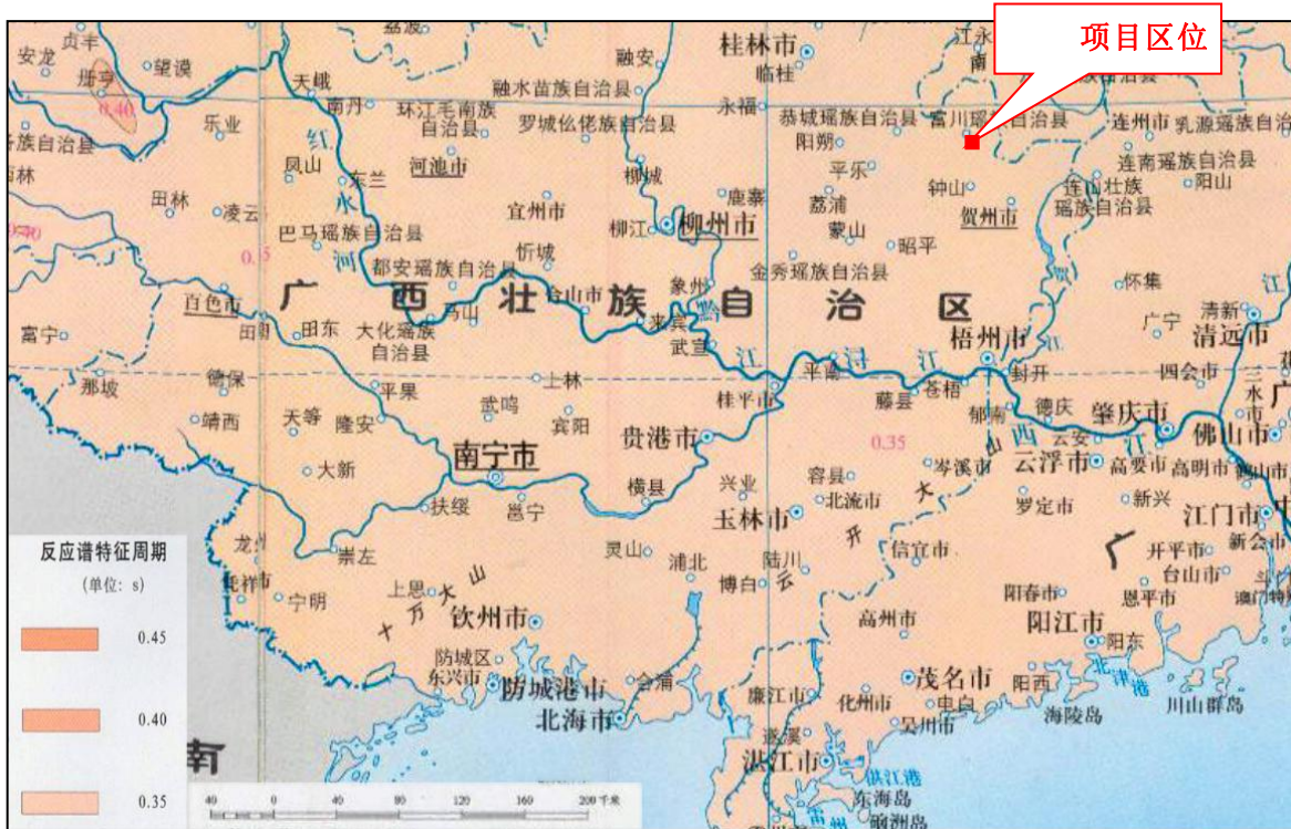
图 3.5-2 广西地震动加速度反应谱特征周期区划图 (引自中国地震动参数区划图 2015 局部)
