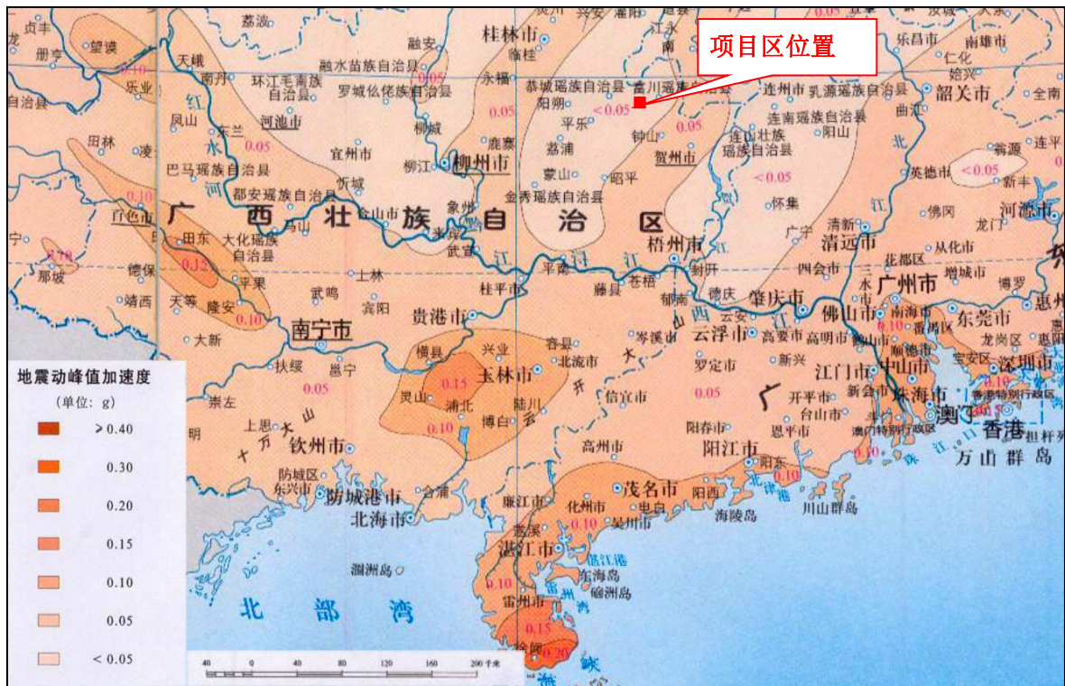
图 3.5-1 广西地震动峰值加速度区划图 (引自中国地震动参数区划图 2015 局部)
